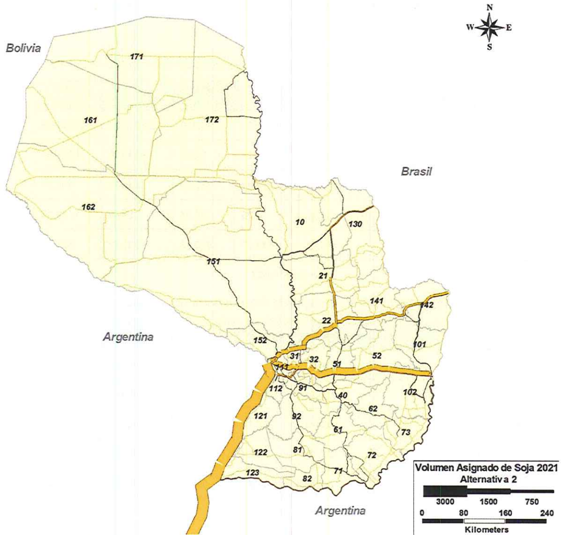
Figura 5-5 – Volumen diario de vehículos de Soja en la Alternativa 2 para el año 2021
